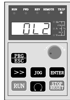
图6 故障时，显示故障代 码TRIP故障指示灯闪烁
