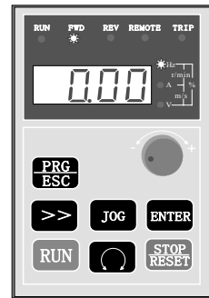
图2 停机状态，RUN灯熄灭 FWD慢闪指示设定方向
