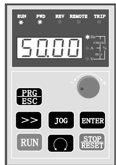
图4 运行状态，RUN灯亮， 运行到设定频率，稳速时FWD恒亮
