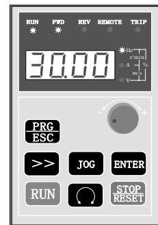
图3 运行状态，RUN灯亮， 加速中FWD指示灯快闪
