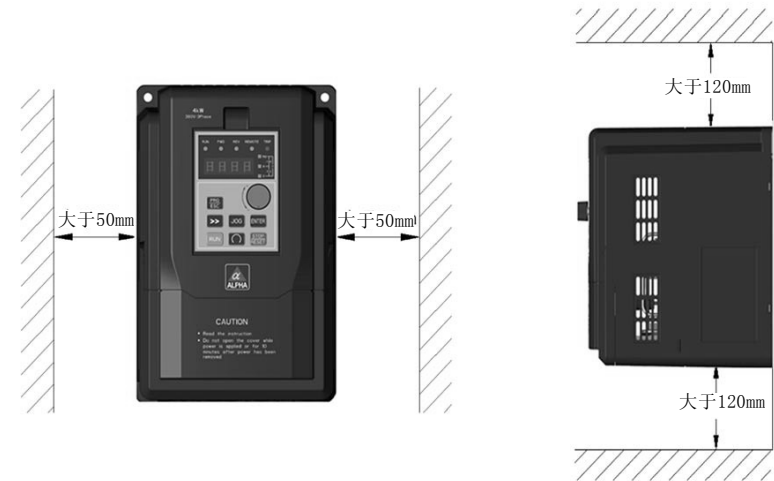
图 2-1 安装方向和空间
