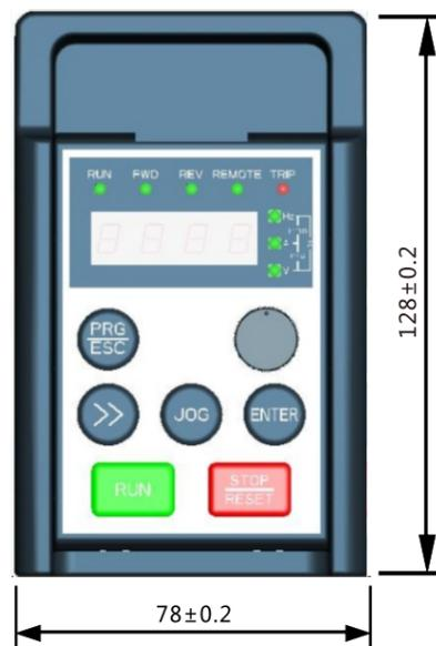
外延托盘安装尺寸 (单位: mm)
