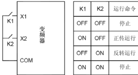
图5-2-1 两线式控制（使能与方向合一）
