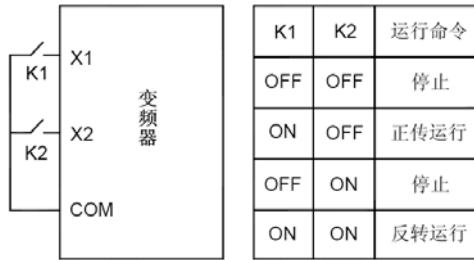
图5-2-2 两线式控制（使能与方向分离）
